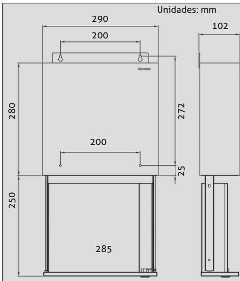
Debe preverse la altura total del dispensador tras el despliegue del cajón de almacenado de las toallitas (ver figura) para asegurar que existe el espacio necesario para su instalación.
