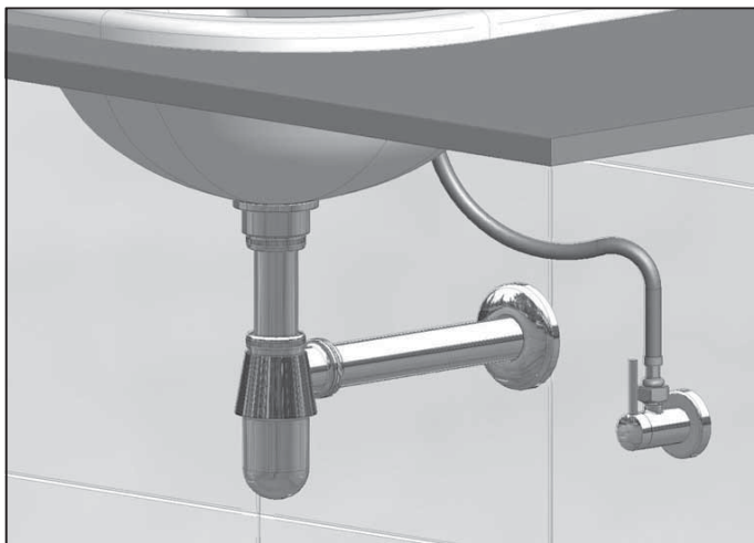
E1. Este es el aspecto final del sifón montado.
