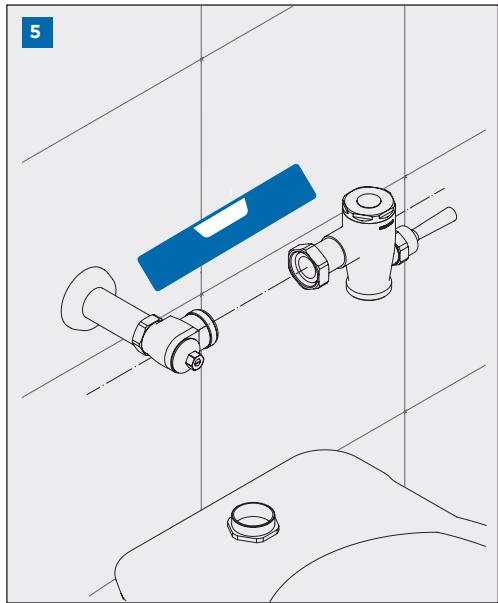
Coloque primeramente el florón y después el bajante armado.
