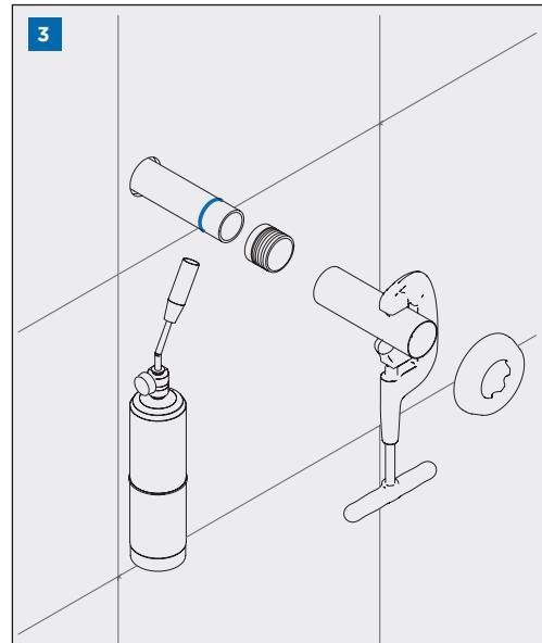
Insertar el florón y la camisa, aplicar teflón y enrosque la válvula de retención.
