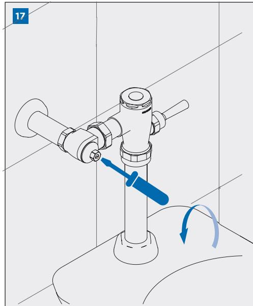
Realizar 3 descargas para estabilizar el funcionamiento.
