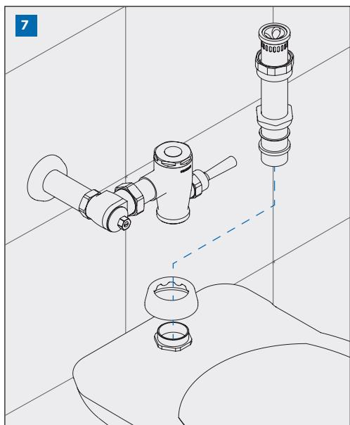
Apriete firmemente el bajante armado y el cuerpo a la válvula de retención.
