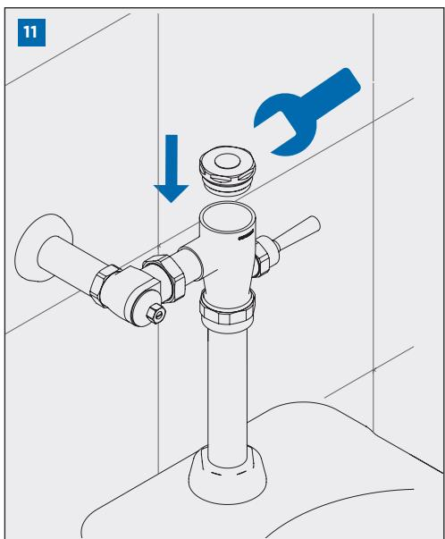
Abra la válvula de retención para purgar el sistema.
