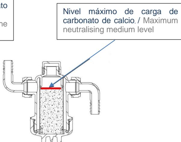
Nivel máximo de carga de carbonato de calcio. / Maximum neutralising medium level
