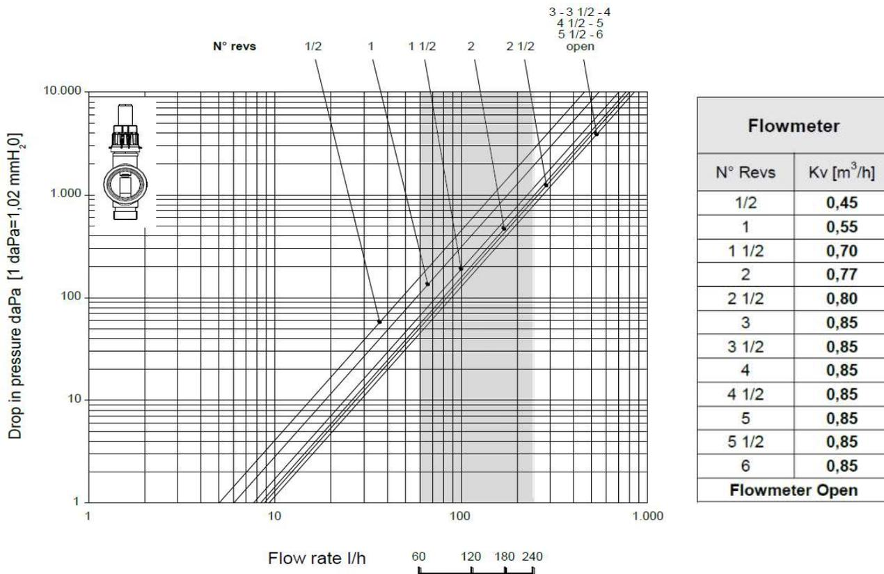
**NOTA:** Al equilibrar los circuitos, hay que evitar una aceleración excesiva de los caudalímetros. La turbulencia generada en esta condición puede causar ruidos y vibraciones irritantes, junto con una disolución excesiva de los gases, suele ser la principal causa de obstrucciones en los circuitos de bobinado (sistemas de piso radiante).
