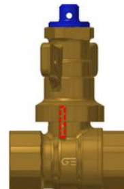
D) Bloqueo en 10% de apertura D) Lock in 10% opening
