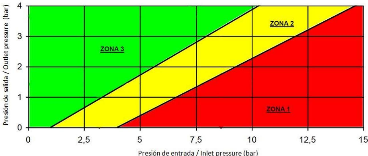
**Zona 1: Zona de cavitación / Cavitation zone:** Evitar hacer trabajar a la reductora de presión en esta zona. / Avoid working within this area.
