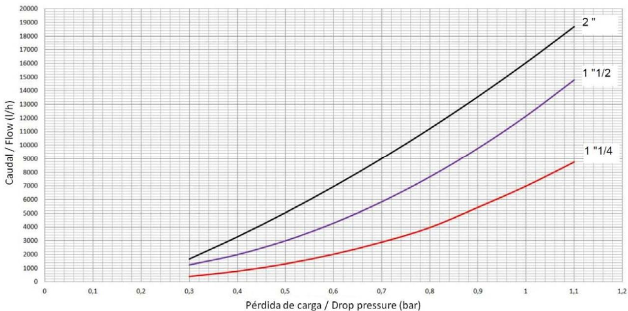
**Lectura del diagrama:** El diagrama de pérdida de carga de la válvula reductora de presión representa la pérdida de presión en función del caudal a la salida de la válvula. / **Reading the diagram:** The pressure drop diagram of pressure reducer valve represents the pressure drop depending on the flow rate in the valve outlet.
