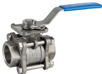
Réf. 2025C Vanne à boisseau sphérique à passage intégral 3 pièces. PTFE + 25 % de graphite 3 pcs full bore ball valve. Seats PTFE +25% graphite
