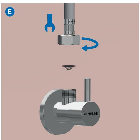
**E.** Roscar la conexión a la válvula de esquina, apretando la tuerca de esta con una llave. Asegurar que la arandela con filtro quede dentro montada en la posición indicada.
