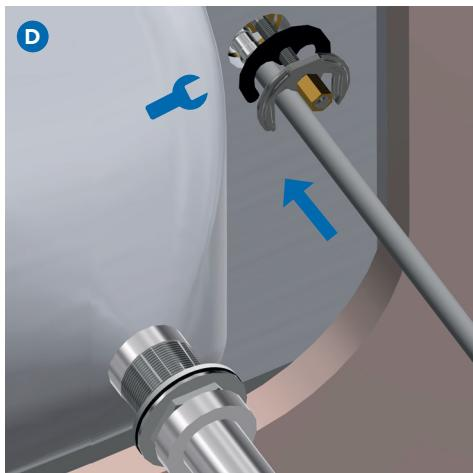
**D.** Por debajo de la encimera del lavabo colocar el resto del conjunto de fijación y apretar con una llave para fijar el grifo.
