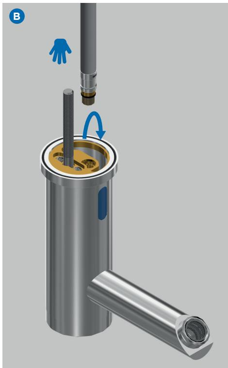
**B.** Roscar la conexión flexible en la base del grifo. La operación se realizará manualmente hasta llegar al tope. No debe emplearse una llave para asegurar la conexión.
