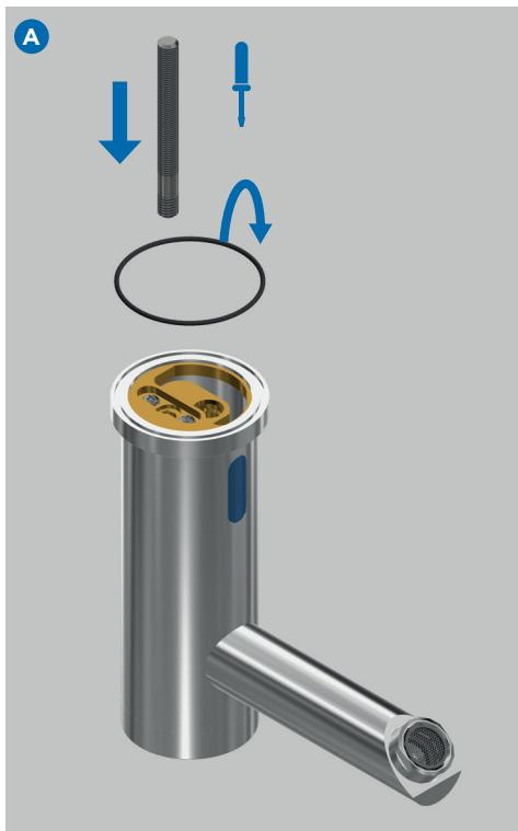
**A.** Montar la varilla roscada apretándola con un destornillador, y colocar la junta tórica de la base.
