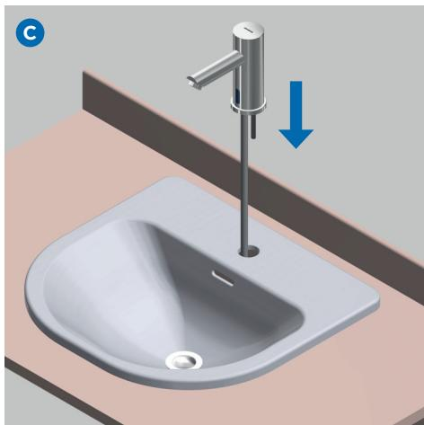
**C.** Introducir la conexión por el taladro de la encimera del lavabo y posicionar el grifo de forma que quede centrado sobre este.
