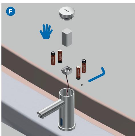
**F.** Quite la tapa del grifo con ayuda de la llave allen suministrada, extraiga el porta pilas e inserte 4 pilas alcalinas AAA, teniendo en cuenta su correcta posición. Vuelva a montar la tapa.
