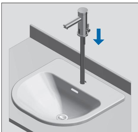
**D.** Introducir las conexiones por el taladro de la encimera del lavabo y posicionar el grifo de forma que quede centrado sobre este.
