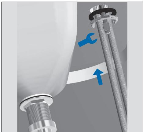
**E.** Por debajo de la encimera del lavabo colocar el resto del conjunto de fijación y apretar con una llave para fijar el grifo.
