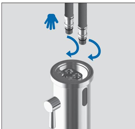
**C.** Roscar las conexiones flexibles en la base del grifo. La operación se realizará manualmente hasta llegar al tope. No debe emplearse una llave para asegurar la conexión.
