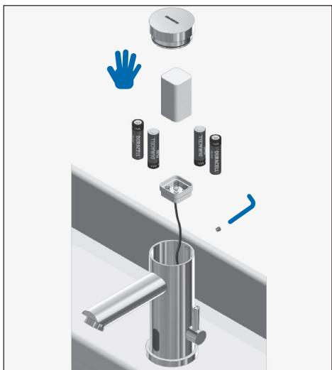
**G.** Quitar la tapa del grifo con ayuda de la llave allen suministrada, extraer el porta pilas e insertar 4 pilas alcalinas AAA, teniendo en cuenta su correcta posición. Volver a montar la tapa.
