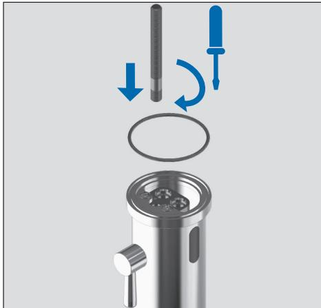
**B.** Montar la varilla roscada apretándola con un destornillador, y colocar la junta tórica de la base.
